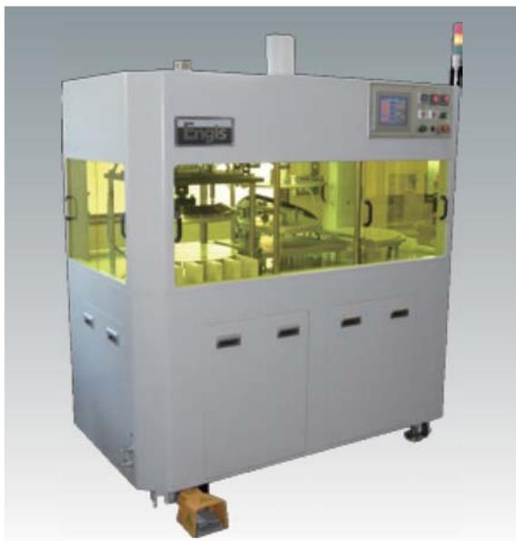
半自動ボンディング装置は、貼付け盤にウェハをワックスで貼りつけるウェハ専用機です。カセットにウェハをセットし、ワックス塗布、加熱、ウェハ搬送、冷却加圧の一連の作業を自動で行えます。
