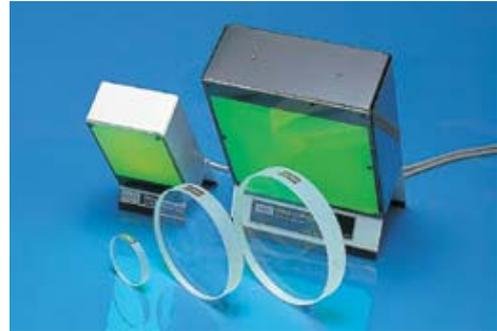
ハイレスFMDランプは旧型ヘリウムランプに代わる最新の光学平坦度測定用器具です。緑の光(波長:5461 Å)がオプチカルフラットをバックアップして鏡面上の干渉縞を鮮明に描き出します。又、ASA400フィルムで干渉縞の鮮明な写真撮影が可能です。
