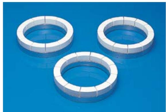
セラミックリングはラップ定盤に噴霧されたスラリーのダイヤモンド砥粒を定盤面に平均にチャージします。セラミックリングの使用によりダイヤモンドが効率良く固定砥粒化しチップングやスクラッチを防ぎます。
