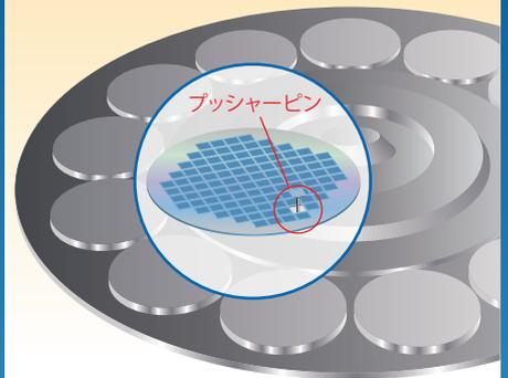
更にマイクロ化した半導体チップのプッシャーピンにも、微細なサイズのセラミック製品が対応します。
