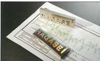
■自由曲面上への回折格子加工例
