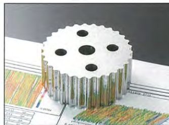
■歯車パンチの超精密成形研削加工
