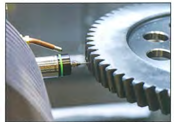
■スキャニングプローブ(OP)による機上測定
