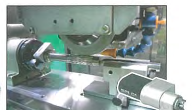
■小型インデックスによる割出加工
