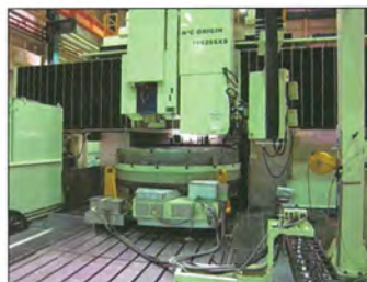
■自社開発のロータリテーブルを載せての加工の様子
