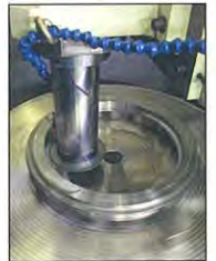
■パーチカルヘッドによる内外径研削加工(OP)
