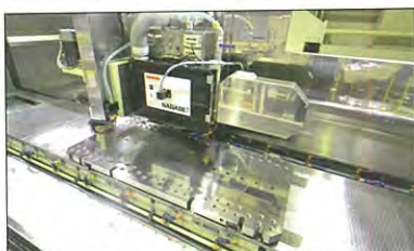
■パーティカルヘッドを用いた 端面研削の様子 (SGC-428S4-Zero3)
