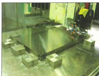
■大型部品の平面研削加工
