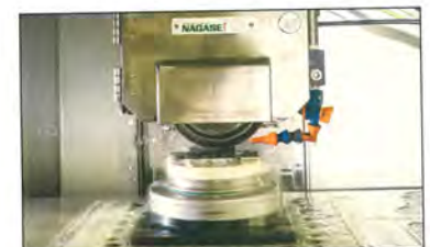
■600反転/min(20mm時の)高速テーブル反転
