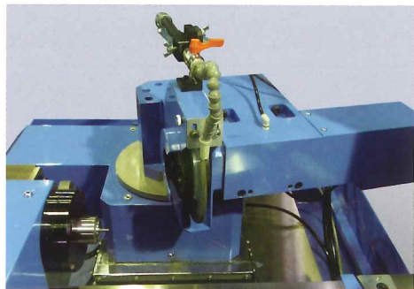
●砥石台NC旋回仕様(砥石径φ205)
