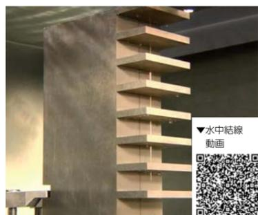
水中での自動結線可能になり、多数個取り等でのトータル加工時間が大幅に短縮可能
