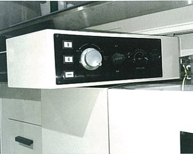
上下早送り鈕、微細切込み及び上下パルスハンドル Fast vertical feed (Up/Down) buttons, fine cutting down button, and Up/Down pulse handle
