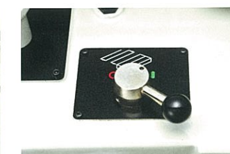
前後送り手動・自動切換レバー (ADグレード) Auto/Manual switching lever for cross-feed (AD grade)
