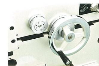
前後送りハンドル・微細送りハンドル (全機種装備) Cross-feed handle, Fine feeding handle (Equipment for all grades)
