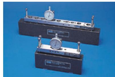
ラッピング定盤の平坦度を測定する装置です。
