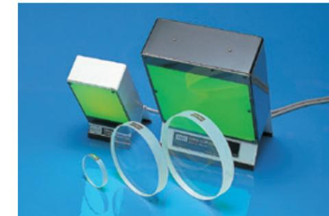
ハイプレスFMDランプは旧型ヘリウムランプに代わる最新の光学平坦度測定用器具です。緑の光(波長:5461 Å)がオプティカルフラットをバックアップして鏡面上の干渉縞を鮮明に描き出します。又、ASA400フィルムで干渉縞の鮮明な写真撮影が可能です。
