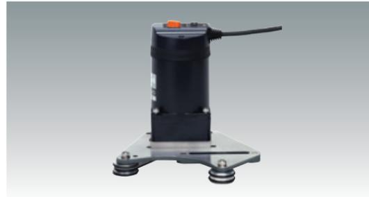
セラミックリング及び加工物を強制的に自転させる為に使用します。
