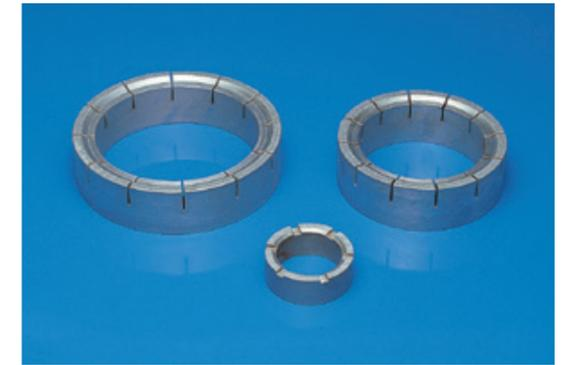
ダイヤモンド電着修正リングは迅速にハイレス定盤の平坦度修正を行うための修正リングです。ダイヤモンド粒子は#60/80、#120/140、#140/170の3種類から選択可能です。
