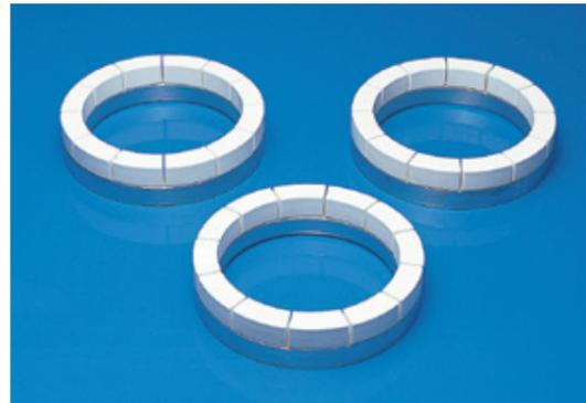
セラミックリングはラップ定盤に噴霧されたスラリーのダイヤモンド砥粒を定盤面に平均にチャージします。セラミックリングの使用によりダイヤが効率良く固定砥粒化しチッピングやスクラッチを防ぎます。
