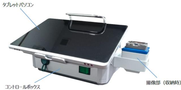
加工機内にセットするカメラ
