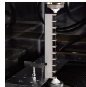
供給困難なく刃形状のスリット部への自動供給も、アニールとフリクションセンサーにより確実にを行うことができます。
